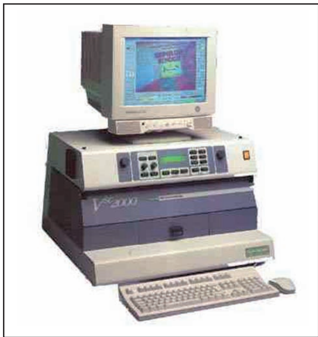
Comparador espectral de video: Capta y registra imágenes de los documentos que son expuestos a la luz blanca, infrarroja y ultravioleta según el caso que se investiga, para ilustrar al perito durante los análisis que se practican y al dictamen si se considera necesario.
