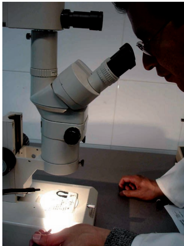
Microscopio estereoscópico: Realiza observaciones físico-ópticas aplicando luz blanca mediante el empleo de la lámpara fría en diferentes posiciones.
